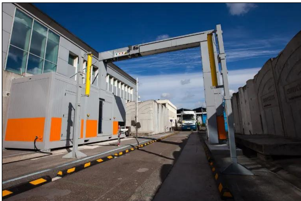
Equipamento para inspeção e triagem de segurança através de raio-x e inteligência artificial em veículos (incluindo os bitrens) com largura máxima de 3,5m e altura mínima de 0,15m e máxima de 4,7m.
